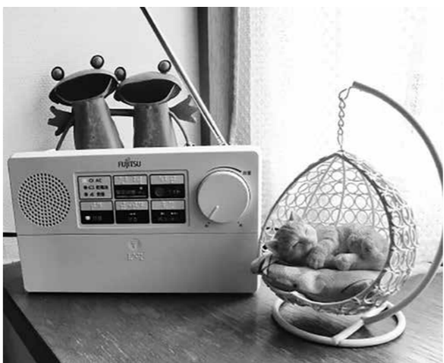
新しく設置された宅内デジタル防災無線受信機
